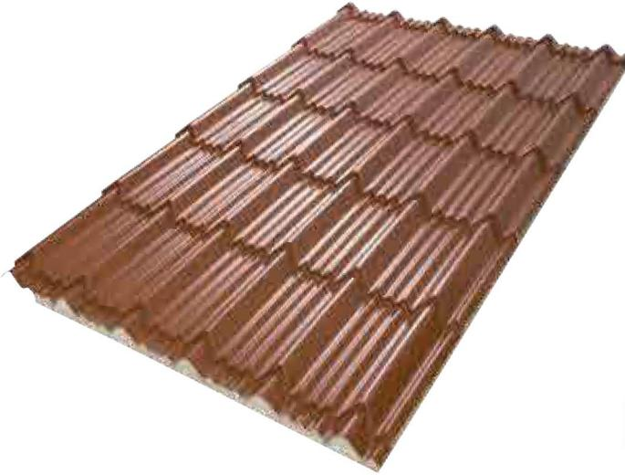
Panel en **núcleo de poliuretano (PUR) o poliisocianurato (PIR)** de alta densidad con recubrimiento en cara superior de **acero galvanizado**, prepintado o cincalum; e inferior con **foil de polipropileno**. Fabricado en proceso de línea continua, es ideal para cubiertas residenciales.
